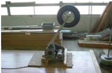
バンガマシン※の 10,000 回落下による衝撃後も、材料の破壊などの異常は見られず、弾力性・歩行感もほとんど変化しないことが確認されています。
